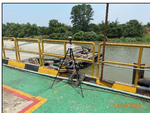
ภาพที่ 3.21 การตรวจวัดระดับเสียงของเรือลากจูง ในพื้นที่โครงการขณะเรือจอด และสตาร์ทเครื่องยนต์
